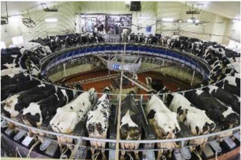
搾乳設備 (ロータリーパーラー)
